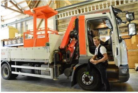
DAF LKW 12 Tonnen mit Kran, Palfinger PK 12002 + Bedienpersonal
